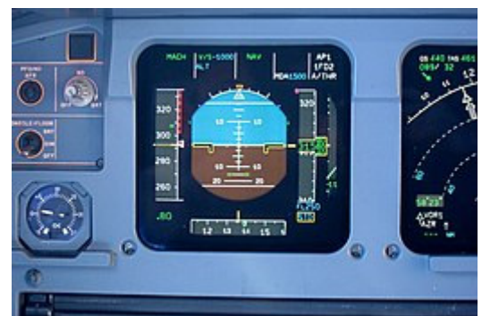
Primary Flight Display eines Airbus A320, auf dem linken Streifen im Display wird die Eigengeschwindigkeit in Knoten angezeigt, die seit dem Flugunfall durch eine längere Linie über die gesamte Breite markiert wird [25]
